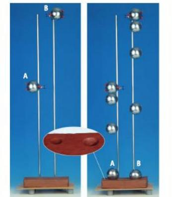
Fig. : Les boules sont fixées puis lâchées à différentes hauteurs pour être photographiées toutes les 110 ms.
