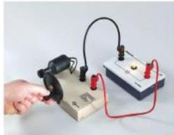
Fig. 2 : La manivelle entraîne l'alternateur.
