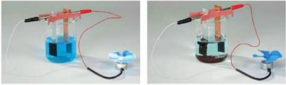
Fig.2 : Aspect du contenu du bécher et fonctionnement du moteur au cours de l'expérience.
