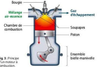
Fig. 3 : Principe d'un moteur à combustion.
