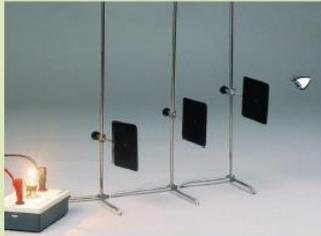
Fig. 1 : La lumière de la lampe doit être visible à travers les trous.
