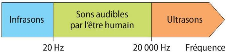
b. Comment nomme-t-on les sons dont les fréquences sont inférieures à 20 Hz ? et ceux dont les fréquences sont supérieures à 20 000 Hz ?
