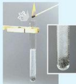
Test caractéristique du dihydrogène réalisé en tube à essais.
